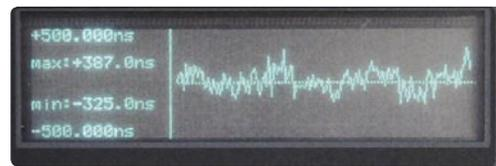
Über das qualitativ hochwertige VF-Display wird eine graphische Repräsentation der Messergebnisse ermöglicht.
